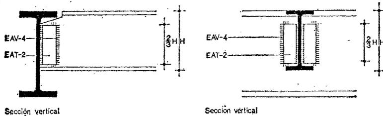
EAT-2 Angulares de perfil LAE de acero laminado para unión de las almas de las vigas y longitud  $2H/3$ , siendo H el canto de la viga embrochalada.
