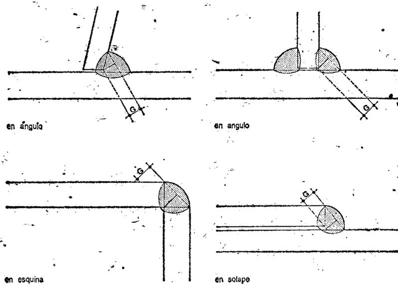
Soldadura en ángulo, en esquina, o en solape, con cordón continuo de espesor de garganta G, siendo G la altura del máximo triángulo isósceles inscrito en la sección transversal de la soldadura, según figura adjunta.
