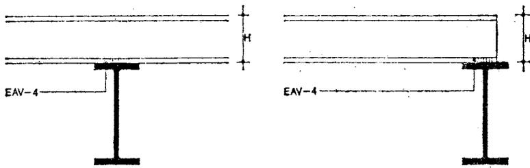
EAV-4 Cordón de soldadura en ángulo de espesor de garganta G para fijar a viga apoyada por ambos lados del ala inferior, en una longitud igual a la mitad de la entrega más 20 mm.
