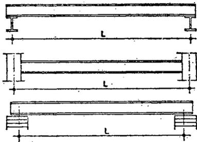
Apoyo en vigas: Distancia entre ejes de vigas
