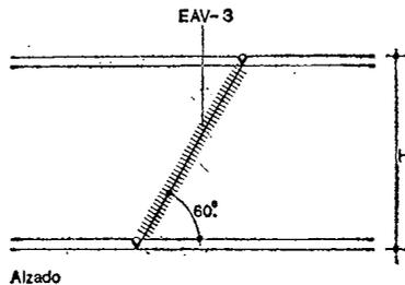
**EAV-3** Cordón de soldadura a tope en el alma y en las alas. Los empalmes de perfiles, estarán situados respecto al apoyo entre  $1/4$  y  $1/8$  de la luz y se realizarán con una inclinación de  $60^\circ$ . Dicha inclinación será aquélla según la cual, el cordón superior de soldadura sea el más próximo al apoyo. No se dispondrá más de un empalme en cada tramo.
