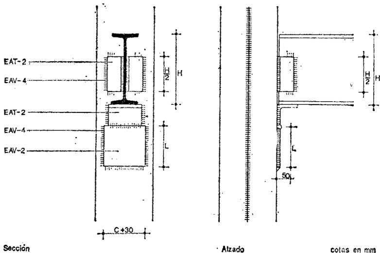
EAT-2 Angular de apoyo de perfil L-A<sub>1</sub>-E<sub>1</sub> y longitud C, de acero laminado seccionada el ala de apoyo para angulares de A<sub>1</sub> mayor 50 mm.
