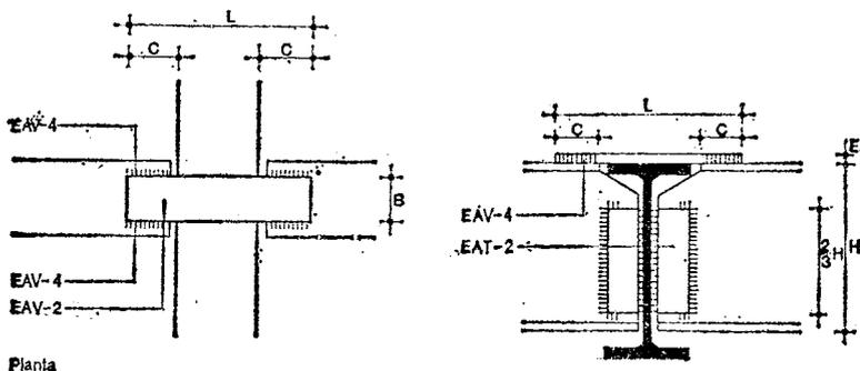
EAT-2 Angulares de perfil LAE de acero laminado para unión de las vigas y longitud  $2H/3$ , siendo H el canto de la viga embrochalada.
