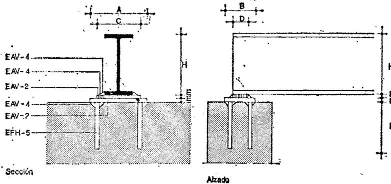
EAV-2 Chapa de anclaje, de acero laminado, de dimensiones A, B y E colocada previamente al hormigonado y posteriormente nivelada y enrasada sobre el vertido del hormigón, de resistencia característica mínima 150 kg/cm<sup>2</sup>.
