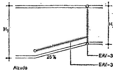
**EAV-3** Cordón de soldadura a tope en el alma y en las alas. En la viga mayor de canto  $H_1$ , se cortará en el alma un cartabón con pendiente del 25% a partir de un taladro previamente realizado en su vértice inferior. La parte inferior del corte se hará girar hasta encontrarse con la parte superior mediante aplicación de soplete y nunca por golpe.
