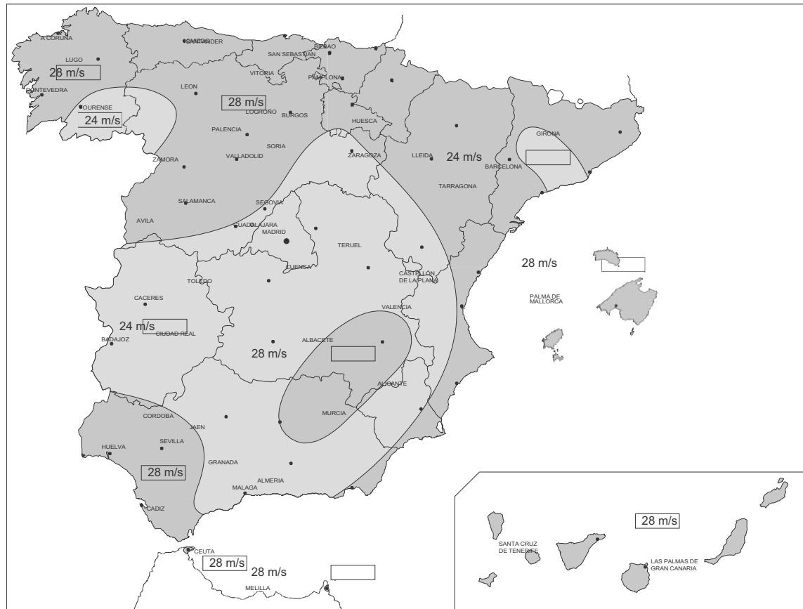
FIGURA 3 - MAPA DE ISOTACAS PARA LA OBTENCIÓN DE LA VELOCIDAD DE REFERENCIA DEL VIENTO
