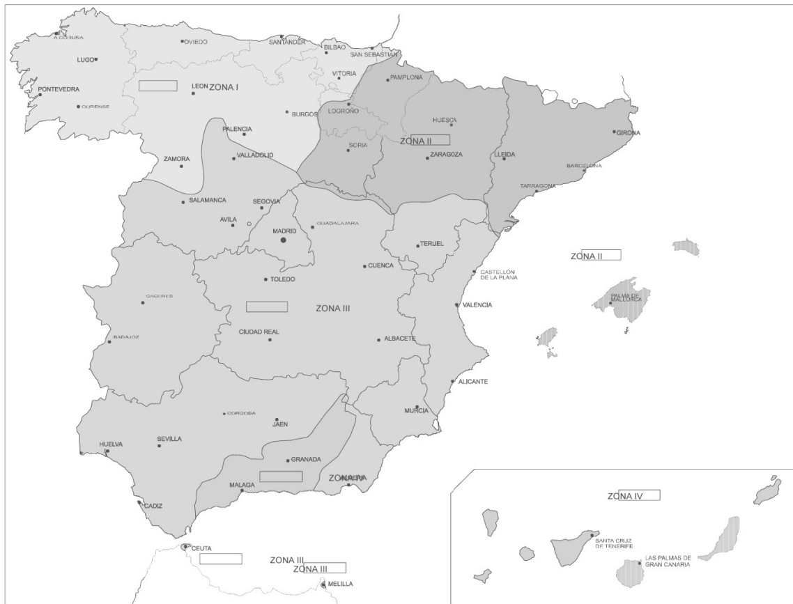
Figura 2.23: Mapa de zonas climáticas para la determinación de la sobrecarga de nieve
