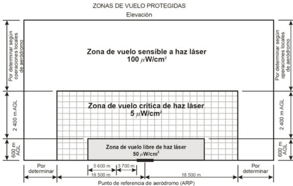
Figura 5-12. Zonas de vuelo protegidas indicando los niveles máximos de irradiación para rayos láser visibles
