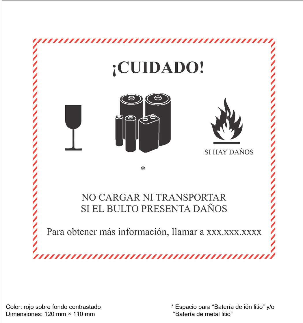
Figura 5-31. Etiqueta de manipulación de baterías de litio
