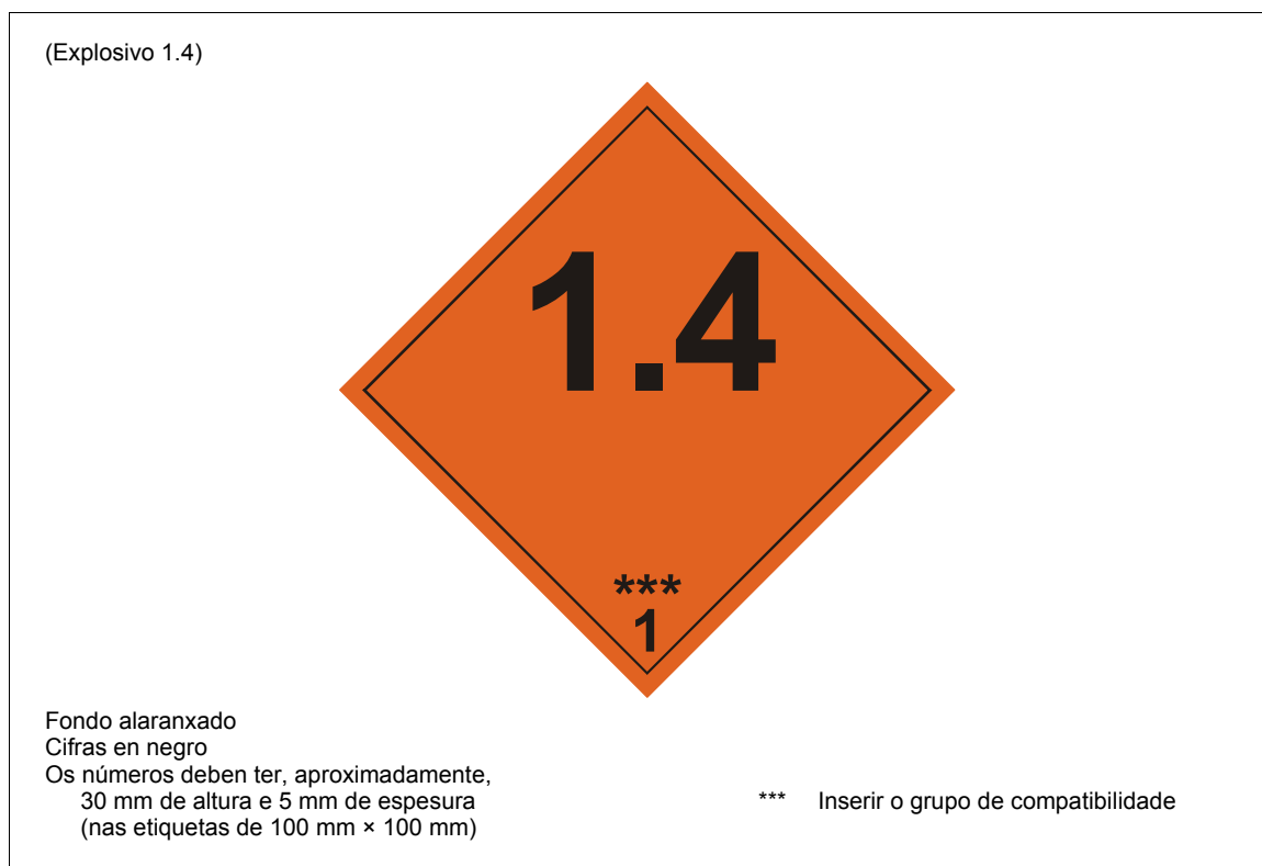
Figura 5-4. Explosivo, clase 1, división 1.4
