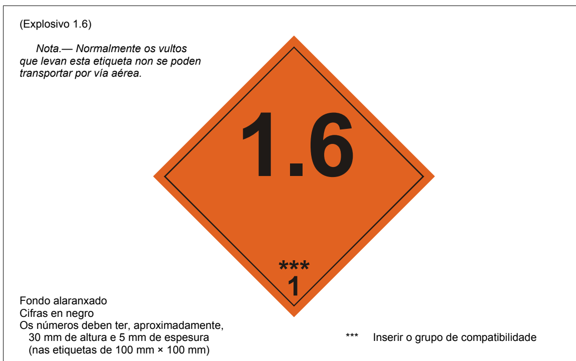
Figura 5-6. Explosivo, clase 1, división 1.6
