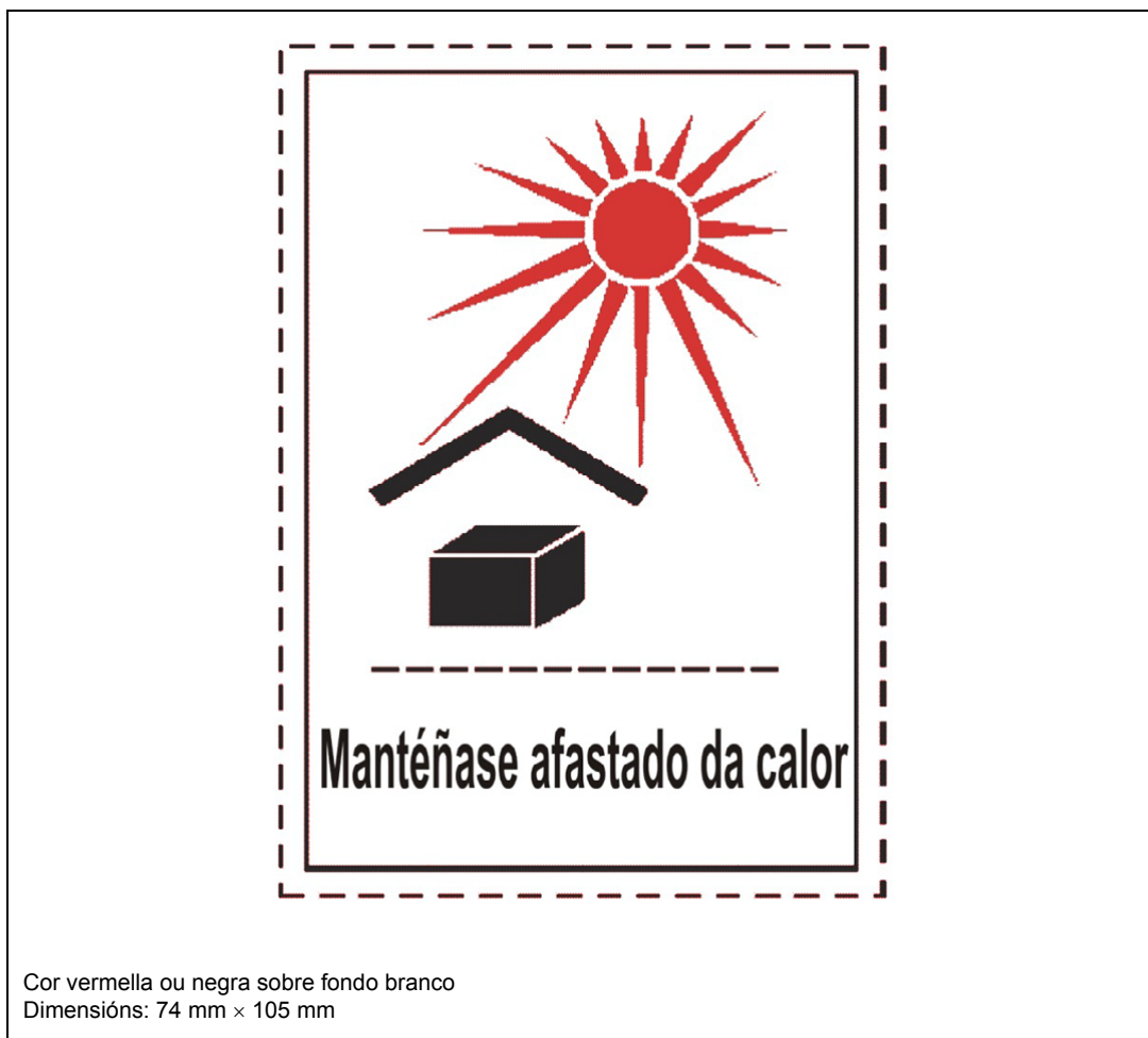
Figura 5-29. Mantéñase afastado da calor
