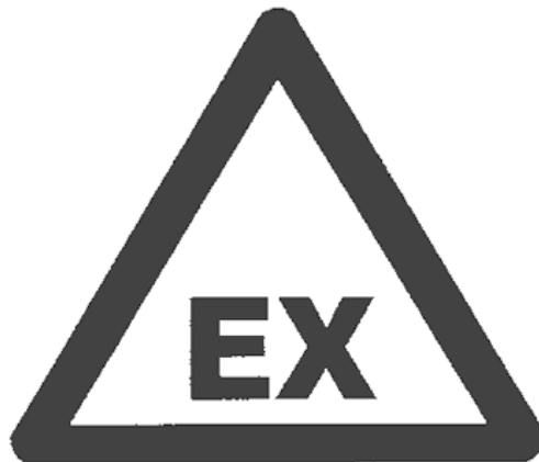
Zona con riesgos de atmósferas explosivas
